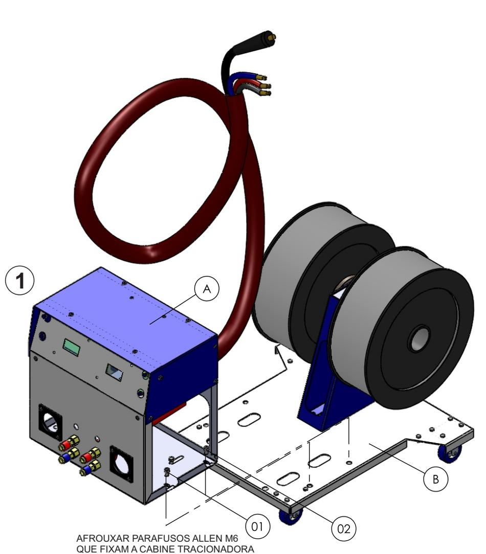
REALIZAR A FURAÇÃO NA BASE ADAPTAÇÃO CONFORME A FURAÇÃO EXISTENTE DO ROBÔ
