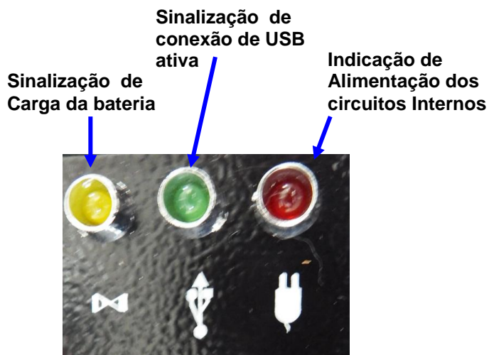
Figura 22 – Leds de sinalização
