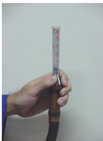
Figura 4.2 – Medição da vazão de gás junto à tocha.
