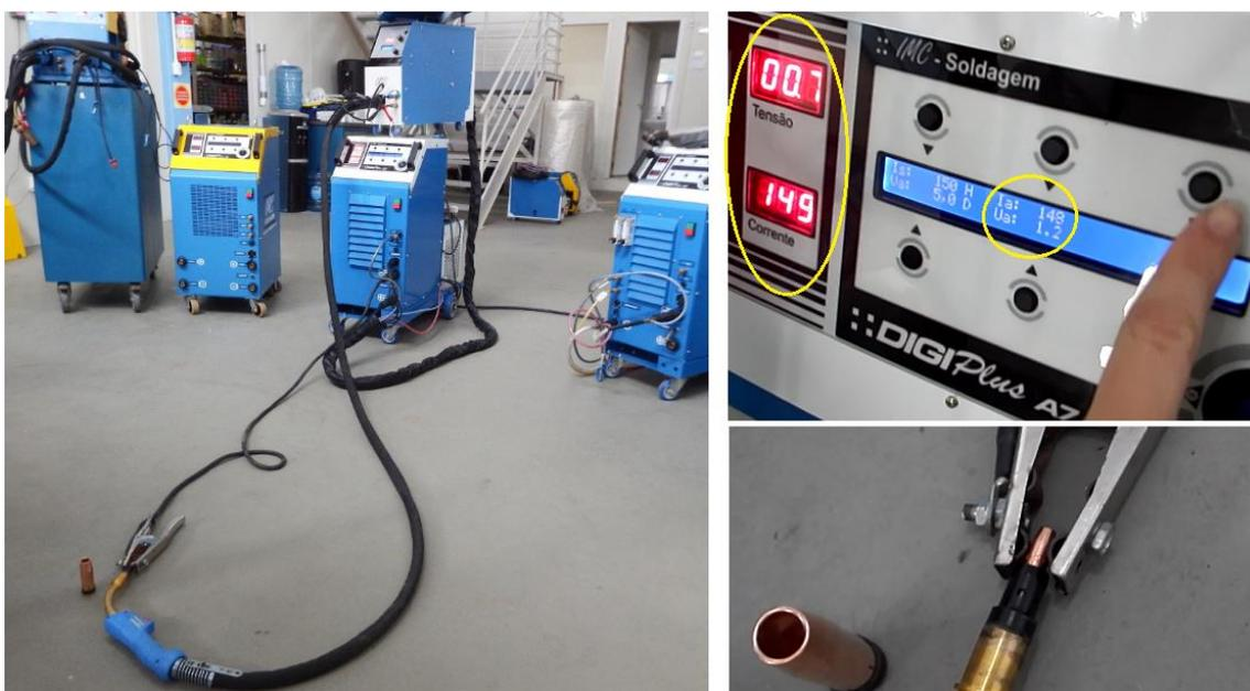
Figura 4 – Ilustração de testes de continuidade da tocha.
